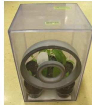
図2 TSWV伝搬実験装置 (25×25×35cm)
